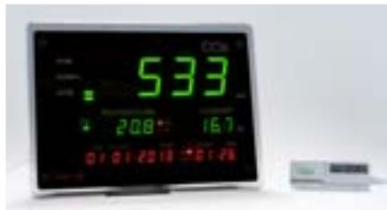
Links das Rotronic CO<sub>2</sub> Display mit Riesenanzeige. Das beste Gerät für Schüler und Studenten, die die Raumluftqualität beobachten und Messreihen auswerten möchten. Rechts das TFA Dostmann AirCO<sub>2</sub>ntrol Mini. Das kleine Gerät misst sehr genau und lässt sich mühelos mitnehmen oder im Bekanntenkreis herumreichen.
