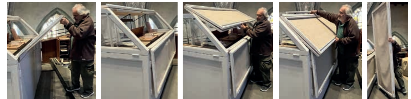
Um das Dach abzubauen klappt man die hintere Dachschräge nach unten und kann so das zweiteilige Dach zusammenklappen, nach hinten rausziehen und zur Seite stellen.
