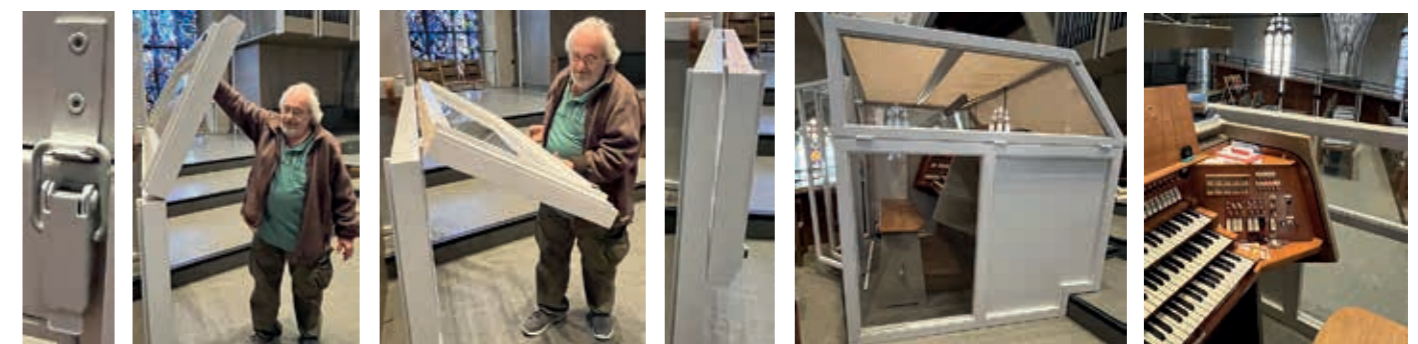
Zum Abnehmen der Seitenwand öffnet man den Spannverschluss und kann so den oberen Teil der Seitenwand nach außen klappen. 2. v. r.: Blick von außen nach innen, so dass man gut Schüler beobachten kann; r.: Blick von innen nach außen bei geöffneter Seitenwand: Einer Chorprobe von der Orgel aus steht nichts im Wege.
