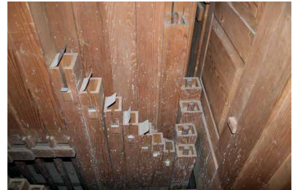
So sieht eine Orgel mit Schimmelbefall aus, wenn man die Fragen des Raumklimas nicht adäquat berücksichtigt.
